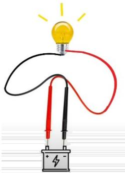
Supongamos que deseamos encender una lámpara para eso necesitamos conectarla por medio de unos conductores a una batería. La lámpara se apagará si interrumpimos la conexión con algunos de los conectores de la batería.
